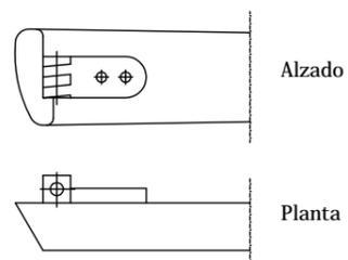
PATILLA DE SUJECCION TIPO CABLE
